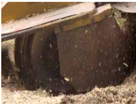
Slike 14. i 15. Mehaničko usitnjavanje korijena, „čipsiranje“ (snimio: A. Vukadin, Italija, 2009.)
