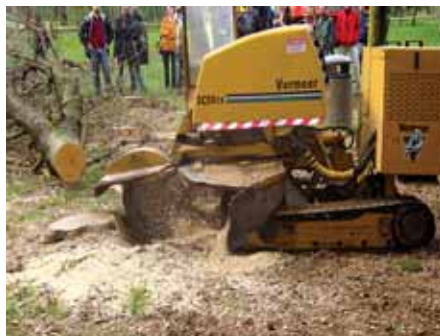
Slike 14. i 15. Mehaničko usitnjavanje korijena, „čipsiranje“ (snimio: A. Vukadin, Italija, 2009.)
